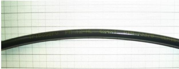
Bild 1: Schlauch PA 12, 6x4
