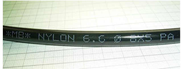
Bild 2: Schlauch PA 6.6, 8x5
